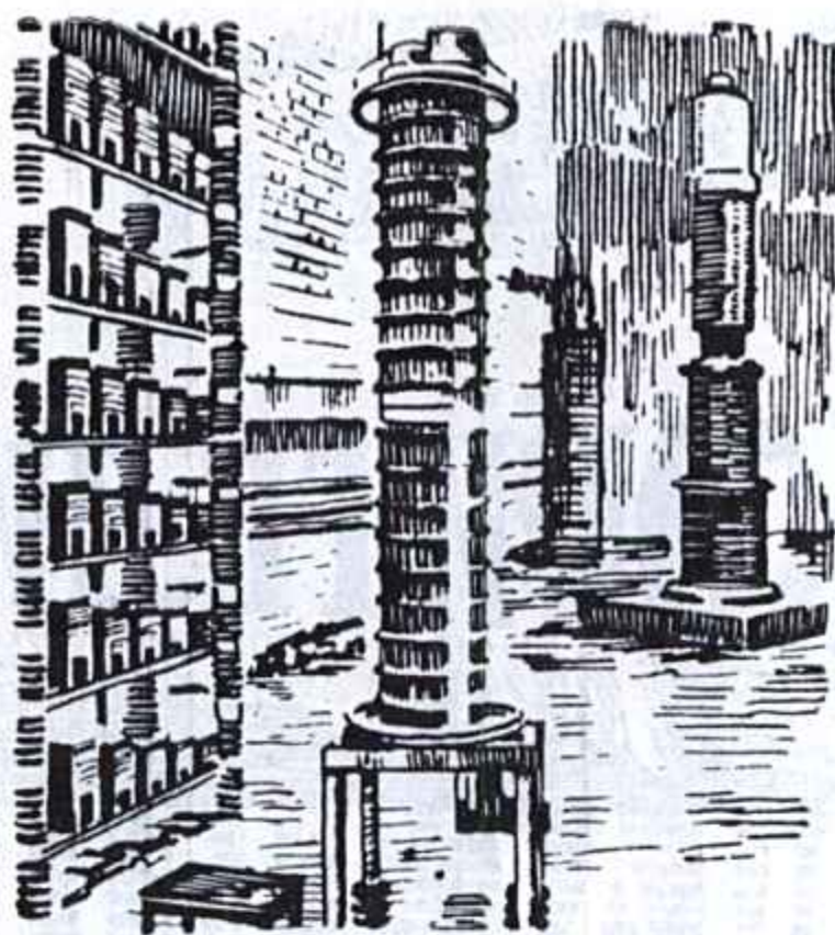
Один из первых электронных ускорителей прямого действия, предназначенный для получения рентгеновских лучей с энергией 3 миллиона электронвольт. Построен во Франции под руководством профессора Жюлио-Кюри. В центре — разборная ускорительная трубка, слева — генератор высокого напряжения, которое подается к верхней части ускорительной трубки, справа — другой генератор высокого напряжения.
